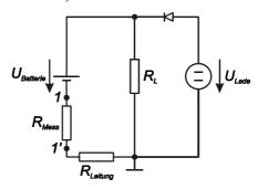
Die Schaltung zeigt das Prinzip für die Messung. Der verwendete Messwiderstand hat einen Wert von 1 m $\Omega$ . Der Akku, der über R<sub>L</sub> entladen wird; wird zusätzlich über ein Ladegerät versorgt. Um die Ladung des Akkus ermitteln zu können, soll ein bipolarer Strom von  $\pm$  100 A gemessen werden können. Der Mikrocontroller verfügt über einen eingebauten A/D-Umsetzer mit einem Eingangsspannungsbeich von -5V-+5V und einer Abtastrate von 100 Hz.
