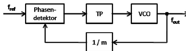
Wie wird die gegebene **PLL-Anwendung** bezeichnet und welche Funktion hat sie? Geben Sie dazu den Zusammenhang zwischen der Frequenz des Referenzsignals und der des Ausgangs an!
