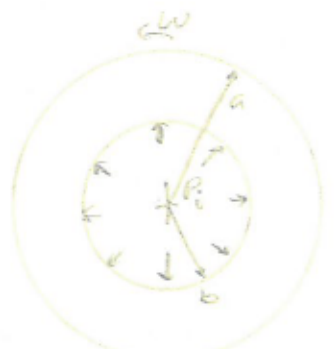
2. drehende Kreisscheibe mit Innendruck p_i
