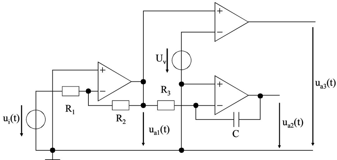
Die induzierte Spannung soll nun in einer ersten Stufe auf  $u_{a1}(v) = 1 \text{ V} \cdot v/1 \text{ ms}^{-1}$  verstärkt werden (Wenn Sie  $u_i(v)$  nicht bestimmt haben, nehmen Sie  $u_i(v) = -20 \text{ mV} \cdot v/1 \text{ ms}^{-1}$  an).
