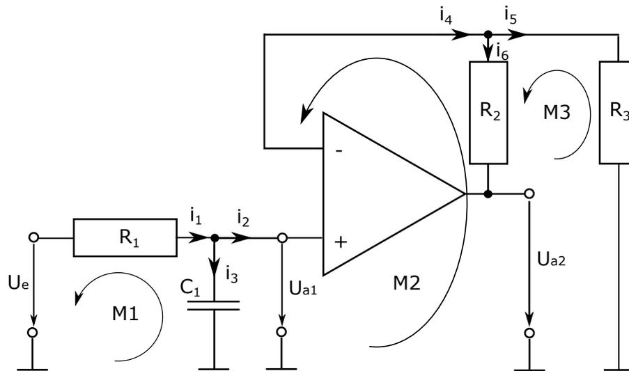
Abbildung 8: Elektrische Schaltung mit Operationsverstärker, Lösung
