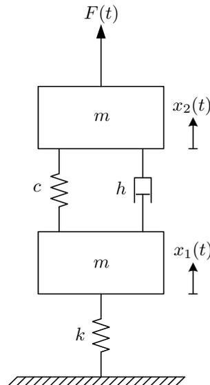
Abbildung 6: Zweimassenschwinger.
