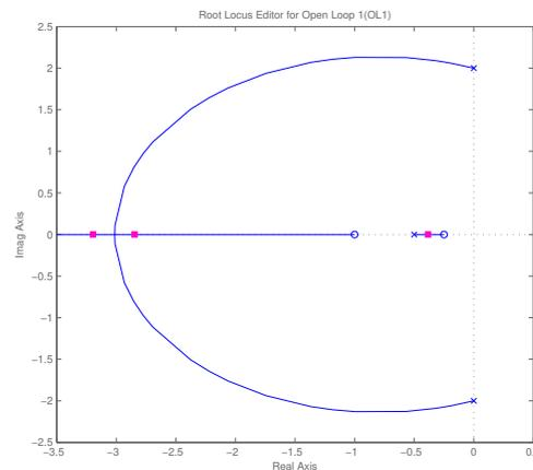
Abbildung 3: WOK as. stabiler nicht schwingungsfähiger Regelkreis
