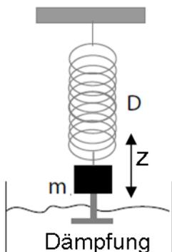
Die Bewegung des Pendels wird durch Reibung eines als masselos angenommenen, angebrachten Kolbens in einer Flüssigkeit gedämpft (siehe nebenstehende Abbildung). Der Betrag der geschwindigkeitsabhängigen Reibungskraft sei  $|\vec{F}_R| = 2m\delta\vec{v}$ . Stellen Sie die Bewegungsgleichung für dieses Feder-Masse-Kolben-System auf! **(1P)**
