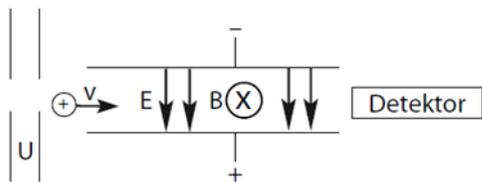
Ein Massenspektrometer ist wie im nebenstehenden Bild aufgebaut. Die Ionen der Masse  $m$  und der Ladung  $q$  werden durch die Spannung  $U = 100 \text{ V}$  beschleunigt und fliegen dann, wenn sich die Kräfte durch  $\vec{E}$ - und  $\vec{B}$ -Feld gerade kompensieren, gerade aus zum Detektor. Das  $\vec{B}$ -Feld betrage  $0.5 \text{ T}$ .
