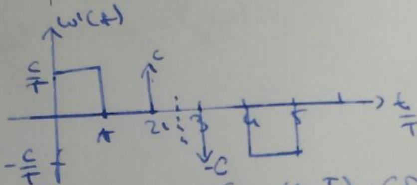
$$w'(t) = \frac{C}{T} \Pi_T(t - \frac{T}{2}) + C\delta(t - 2T) - C\delta(t - 3T) - \frac{C}{T} \Pi_T(t - \frac{3}{2}T)$$
