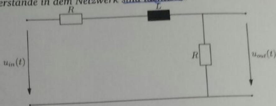
a) Bestimmen Sie die Übertragungsfunktion des Systems  $H(s)$  im Laplacebereich unter Verwendung komplexer Impedanzen.
