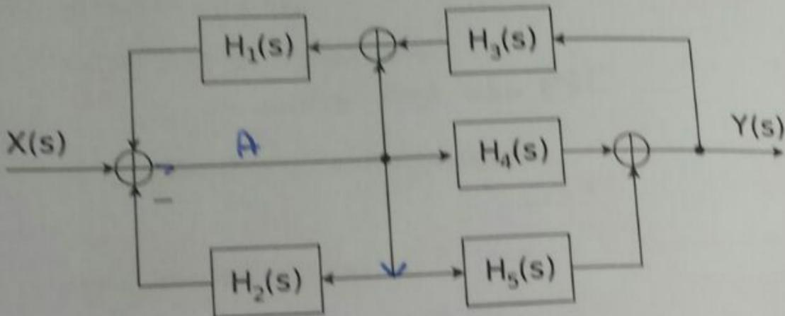
$$Y = H_4(X + H_1(H_3Y + A)) - H_2A$$
