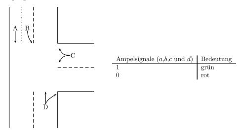
(a) (2 Punkte) Ergänzen Sie zur Prüfung der Ampelanlage folgende Wertetabelle. Dabei liegt am Ausgang y eine 1 genau dann an, wenn mindestens zwei sich schneidende Fahrtrichtungen mit grün freigegeben werden.
