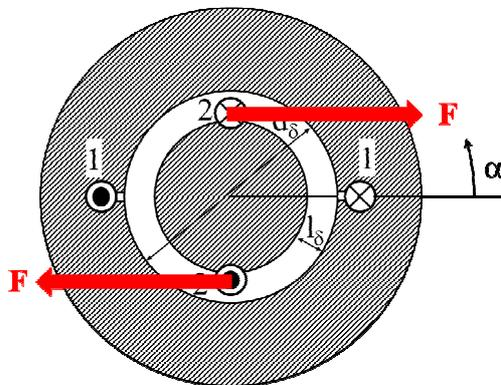
Lorentzkraft (hier wg. rechter Winkel skalar formuliert):  $F = I \cdot l \cdot B = 126 \frac{\text{N}}{\text{m}} \cdot l$ , falls  $l$  aus nächster Frage noch nicht berücksichtigt, oder bei Berücksichtigung der Länge von 100 mm:  $F = 12,6 \text{ N}$
