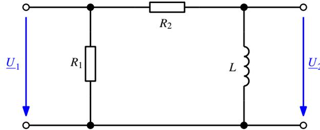
**5.1. Übertragungsfunktion (2 Punkte)** Bestimmen Sie die komplexe Übertragungsfunktion  $\underline{V}$  des Zweitores in Normalform (= Produkt von Teilfunktionen).
