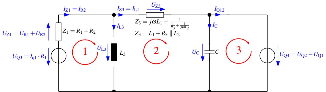
**3.3. Maschengleichungen (3 Punkte)** Stellen Sie für die Maschen 1...3 die zugehörigen Maschengleichungen auf. Sortieren Sie diese so um, dass sich daraus die Elemente der Impedanzmatrix direkt ablesen lassen.
