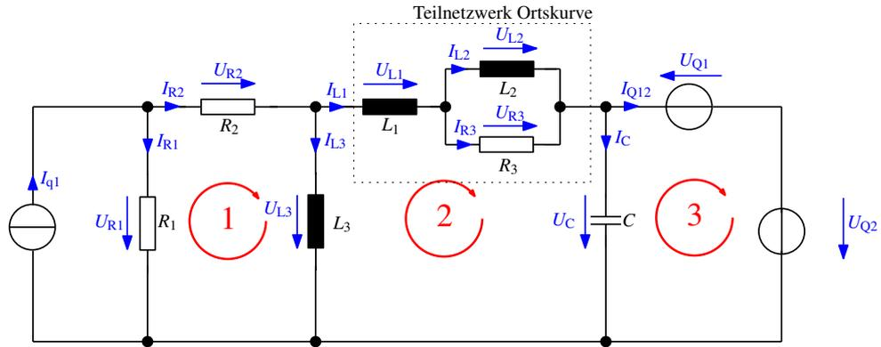
**3.1. Ortskurve (3 Punkte)** Skizzieren Sie die Ortskurve der Impedanz  $\underline{Z}(\omega)$  für das Teilnetzwerk bestehend aus  $L_1$ ,  $L_2$  und  $R_3$  (gestrichelter Kasten) im unten stehenden Diagramm. Tragen Sie hierfür die Teilortskurven auf und konstruieren Sie daraus den Gesamtverlauf.
