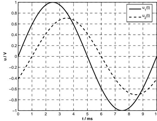
Bestimmen Sie aus den obigen Zeitverläufen den Phasenwinkel  $\varphi_2$  von  $\underline{U}_2$  bezogen auf  $\underline{U}_1$ .
