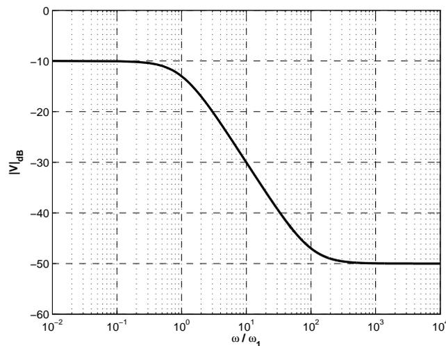
Sie messen den oben stehenden Betragsfrequenzgang. Stellen Sie diesen durch eine Übertragungsfunktion in Normalform dar.
