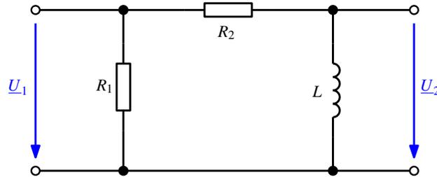
**5.1. Übertragungsfunktion (2 Punkte)** Bestimmen Sie die komplexe Übertragungsfunktion  $\underline{V}_d$  des Zweiteiles in Normalform (= Produkt von Teilfunktionen).
