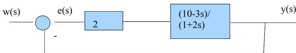
Ermitteln Sie die Störübertragungsfunktion bezüglich der Stellgröße  $G_s(s) = u(s)/z(s)$  zu Abbildung 5 ohne Anwendung der Faustregel. (5P)
