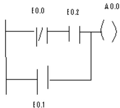
b) Speicherprogrammierte Steuerung: Geben Sie die Funktion des Programms in Abb. 3 an. Erstellen Sie eine Wahrheitstabelle mit den Eingängen E0.0, E0.1 und E0.2 (7)
