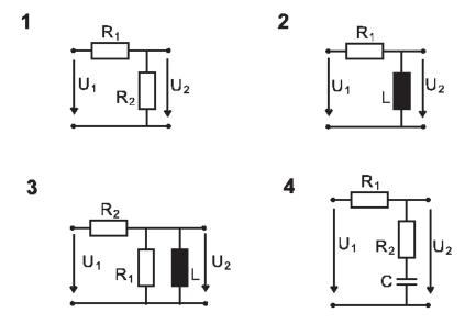
Für die folgenden Berechnungen gelten die Daten:  $R_1=1000\Omega,\,R_2=27\Omega,\,L=1\mu H,\,C=33pF.$
