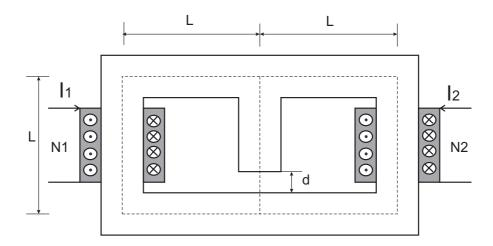
L=10cm, d=1mm (Luftspalt), Querschnitt =  $1cm^2, \mu_0=1,256\cdot 10^{-6}Vs/Am, \mu_r=1000/1,256$   $I_1=2A, I_2=1A, N_1=1000, N_2=250$
