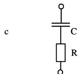
15. Mit welcher passiven Bauelemente-Kombination können Sie den Strom einer Spannung um  $75^\circ$  voreilen lassen?
