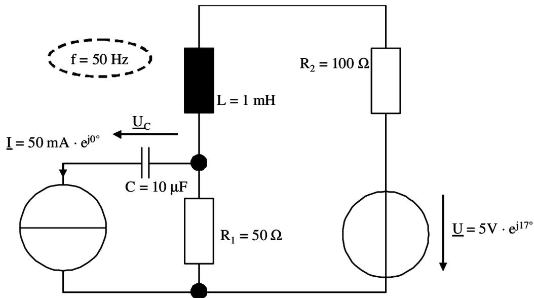
Beide Quellen I und U arbeiten mit der Frequenz  $f = 50 \text{ Hz}$ .
