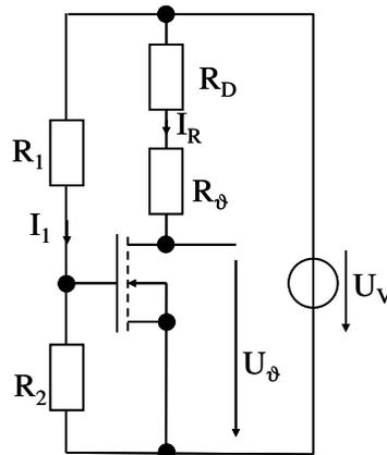
Der Widerstand soll von einem konstanten Messstrom  $I_R = 1 \, \text{mA}$  durchflossen werden. Dazu wird eine Konstantstromquelle mit einem MOSFET verwendet. Dieser kann vollständig beschrieben werden durch:
