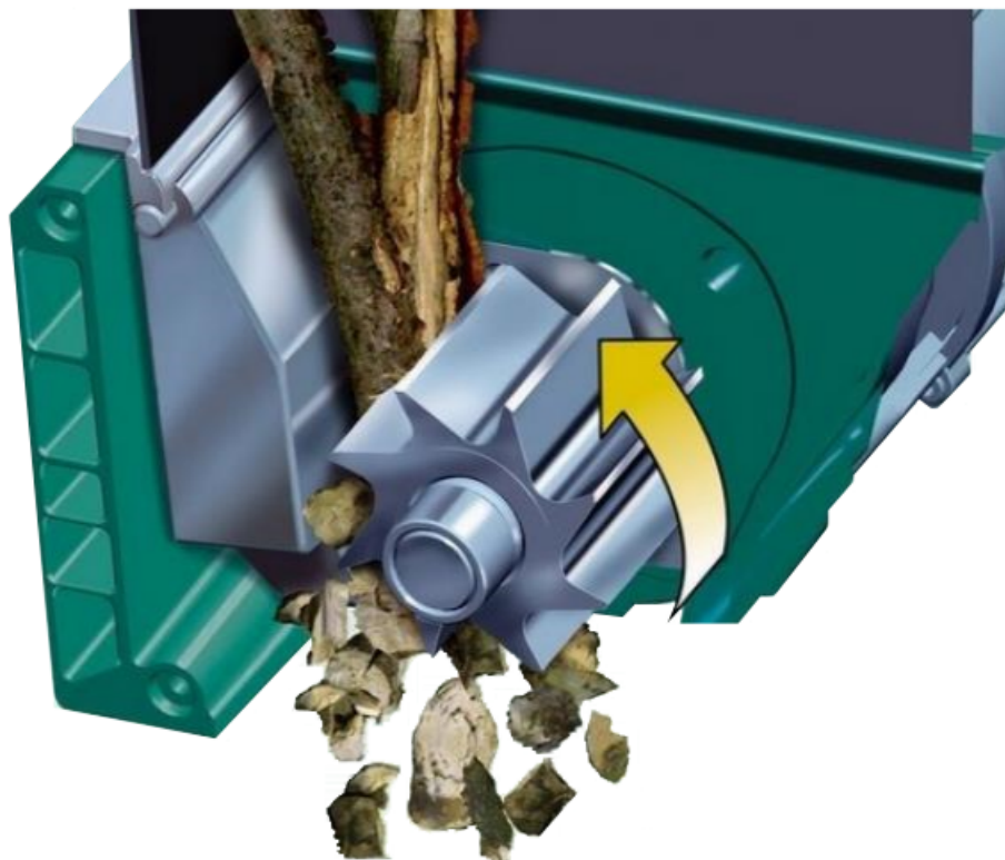
Abbildung 1: Funktion eines Häckslers (Quelle: http://bit.ly/1gq72dq )
