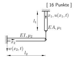
Geben Sie die Bewegungsgleichungen (Feldgleichungen) für den Dehnstab und den Balken in Abhängigkeit der gegeben Größen an.
