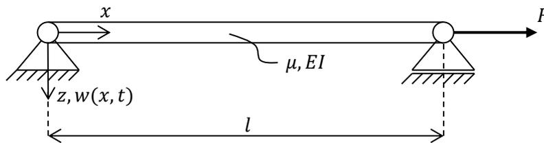
Gegeben ist der skizzierte mit der Kraft  $F$  vorgespannte Balken (Masse pro Länge  $\mu$ , Biegesteifigkeit  $EI$ , Länge  $l$ ). Seine Feldgleichung ist
