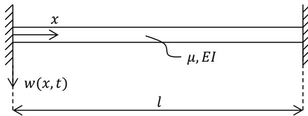
Gegeben ist der skizzierte, beidseitig fest eingespannte Euler-Bernoulli-Balken (Masse pro Länge  $\mu$ , Biegesteifigkeit  $EI$ , Länge  $l$ )
