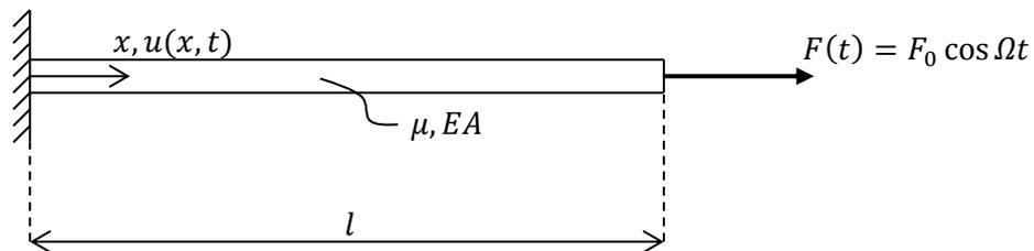
Gegeben ist der wie skizziert gelagerte Stab (Masse pro Länge  $\mu = \rho A$ , Dehnsteifigkeit  $EA$ , Länge  $l$ ), der durch die Kraft  $F(t) = F_0 \cos \Omega t$  zu Längsschwingungen  $u(x, t)$  angeregt wird.
