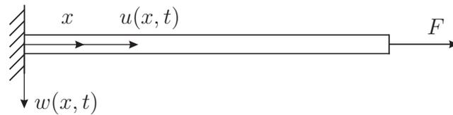
Welchen Einfluss hat  $F$  auf die Eigenkreisfrequenzen  $\omega$  der Stablängsschwingungen bzw. der Biegeschwingungen?
