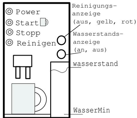
Die Taste *Power* dient dazu, die Kaffeemaschine ein- bzw. auszuschalten. Bevor die Maschine ausgeht, startet automatisch ein *Reinigungsprogramm*, falls seit der letzten Reinigung bereits Kaffee zubereitet wurde. Ansonsten geht die Maschine direkt *aus*. Das *Reinigungsprogramm* nimmt eine Minute in Anspruch. Zu beachten ist, dass die Maschine nur ausgeschaltet werden kann, wenn sie eingeschaltet ist und zu diesem Zeitpunkt keinen Kaffee zubereitet.
