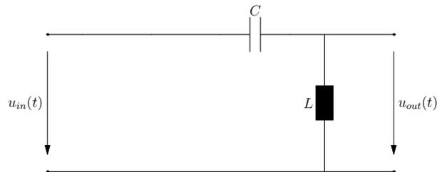
a) Bestimmen Sie die Übertragungsfunktion  $H(s)$  des Systems im Laplacebereich unter Verwendung der komplexen Impedanzen. 2 P
