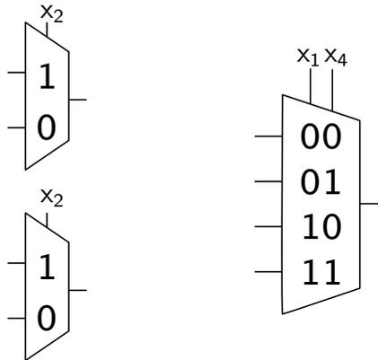
Die Ausgänge der 2 zu 1 Multiplexer lassen sich mit beliebigen Eingängen des 4 zu 1 Multiplexers verbinden.
