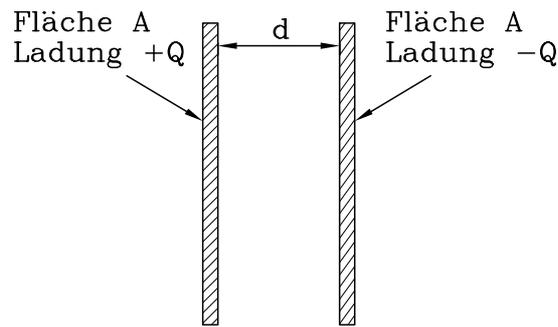
Bestimme die Kraft auf eine der Platten mit Hilfe des Prinzips der *virtuellen Verrückung*.
