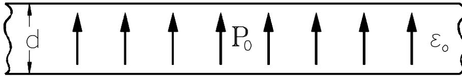
Ersatzanordnung: zwei Polarisationsflächenladungen  $\pm q_{Fpol}$  auf der Ober- bzw. Unterseite der Platte.
