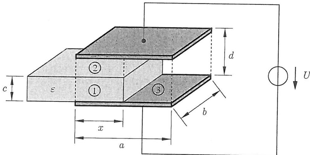
Bestimme mit Hilfe des Prinzips der virtuellen Verrückung die Kraft, mit der die dielektrische Platte weiter in den Kondensator hineingezogen wird.
