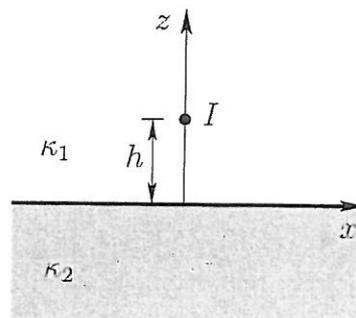
Leite mit Hilfe der Stetigkeitsbedingungen im stationären Strömungsfeld Ersatzanordnungen zur Berechnung der elektrischen Feldstärke in den jeweiligen Halbräumen her.
