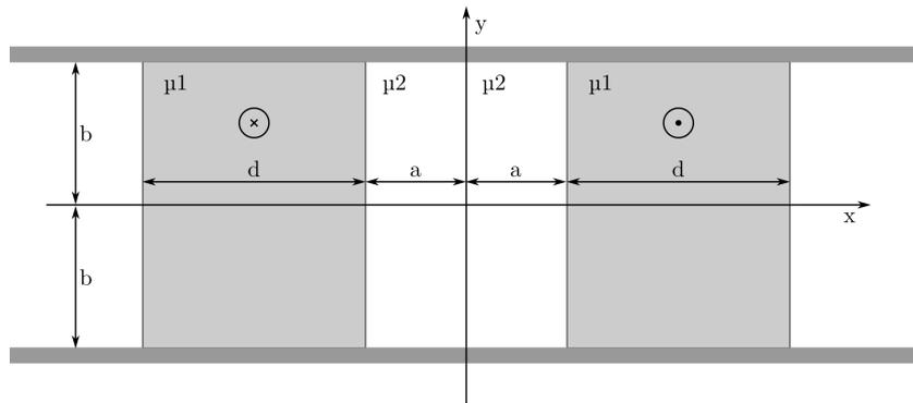
Abbildung 4: zwei durch nichtleitenden Raum getrennte Massivleiter
