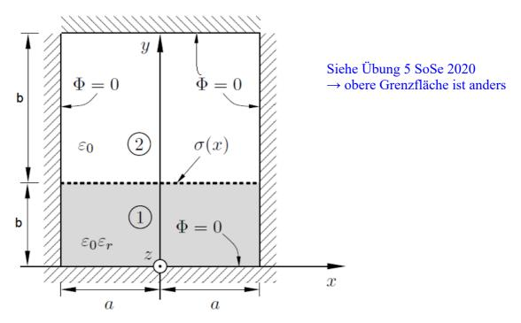
Die Ebenen  $x = \pm a$  sowie die Ebene y = 0 sind leitend und geerdet und weisen folglich das Potential = 0 auf. Innerhalb des von den leitenden Ebenen begrenzten Bereiches, befindet sich in der Höhe beine Flächenladung mit der Dichte:
