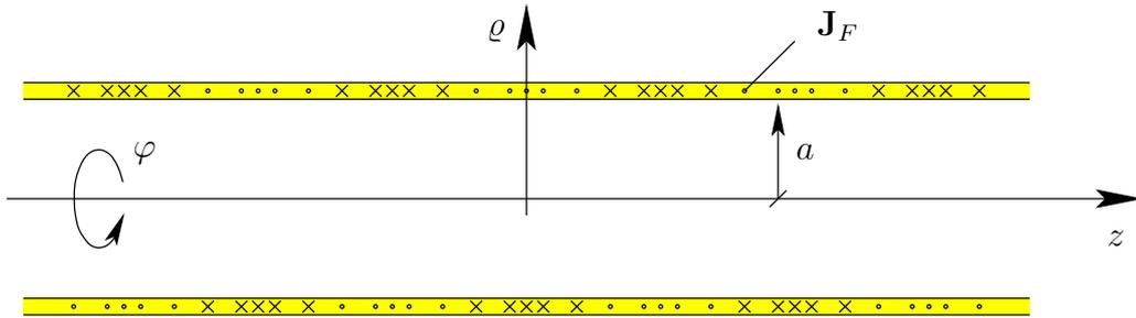
Zu berechnen ist das magnetische Vektorpotential in den Bereichen  $\varrho \leq a$  und  $\varrho \geq a$ .
