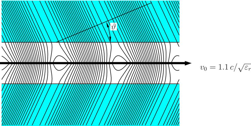
**c)** Wir betrachten nun anstelle der Flächenladung eine bewegte Linienladung  $q_L$  im homogenen Gesamttraum mit der relativen Dielektrizitätskonstanten  $\varepsilon_r$ . In diesem Fall wird sicherlich keine monochromatische Welle abgestrahlt, weshalb sich eine FOURIERtransformation anbietet. Wir gehen aus von der Wellengleichung
