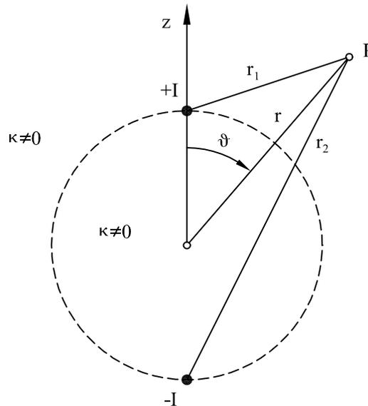
Abbildung 1: Punktförmige Stromquelle und -senke im homogenen Gesamttraum der Leitfähigkeit  $\kappa$
