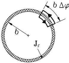
$$\oint \mathbf{H} \cdot d\mathbf{s} = (0 - H_\varphi|_{\varrho=b}) b \Delta \varphi = J_{F0} b \Delta \varphi \sin \varphi$$
